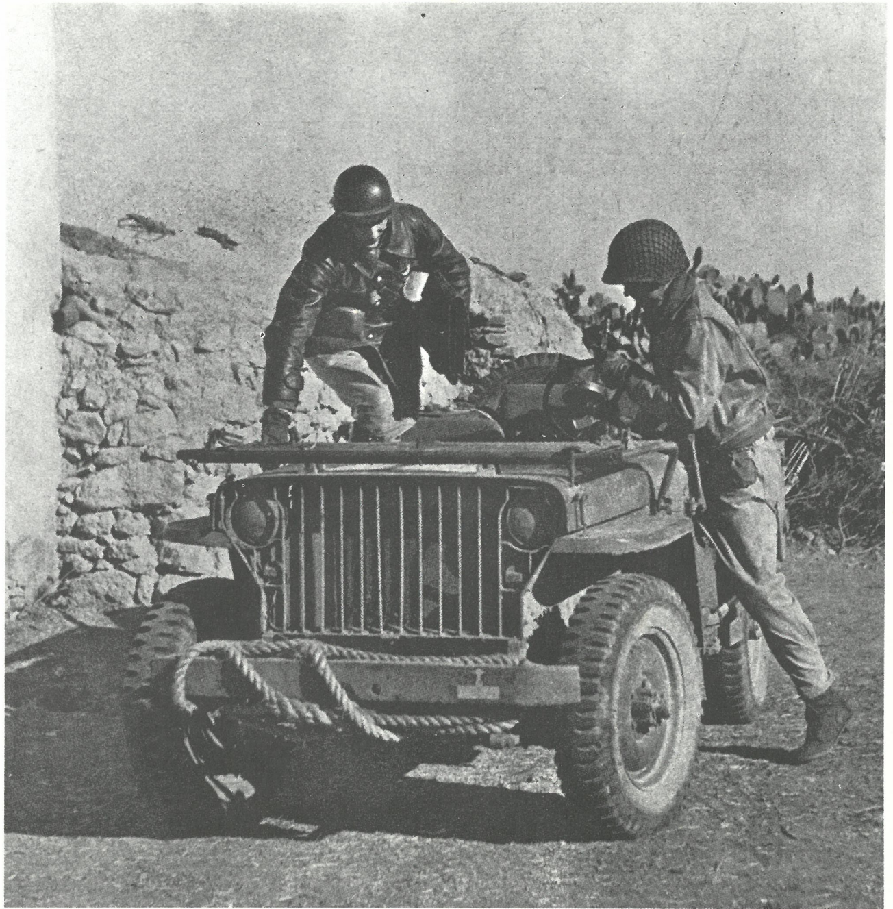
Une des premières Jeep Ford (MB) reconnaissable à la calandre en fer soudé et qui furent livrées aux forces françaises libres, en Afrique du Nord
