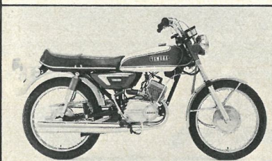
CS5E 25 hk/7.500 omdr. 140 km/t. Autolube. 5 gear, elektr. starter Kr. 6.882,- excl. lev.
