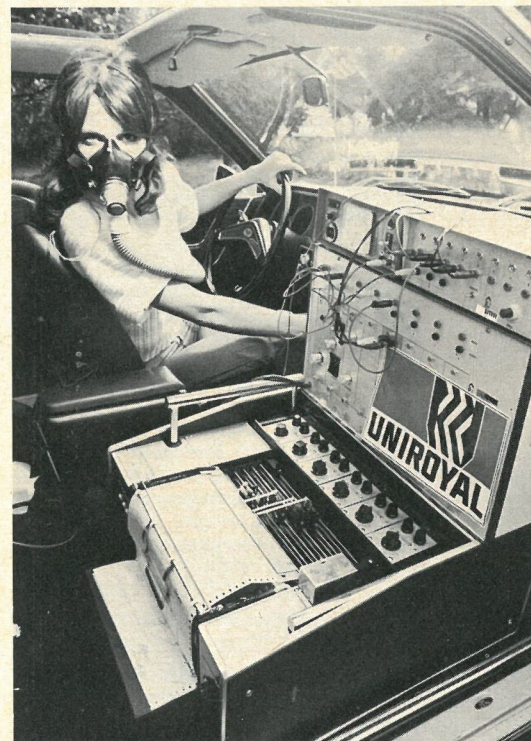
Forsøgsvognene var udstyret med dette måleudstyr, som registrerede at det var mindre trættende og mindre belastende for nervesystemet at køre med automatgear.
