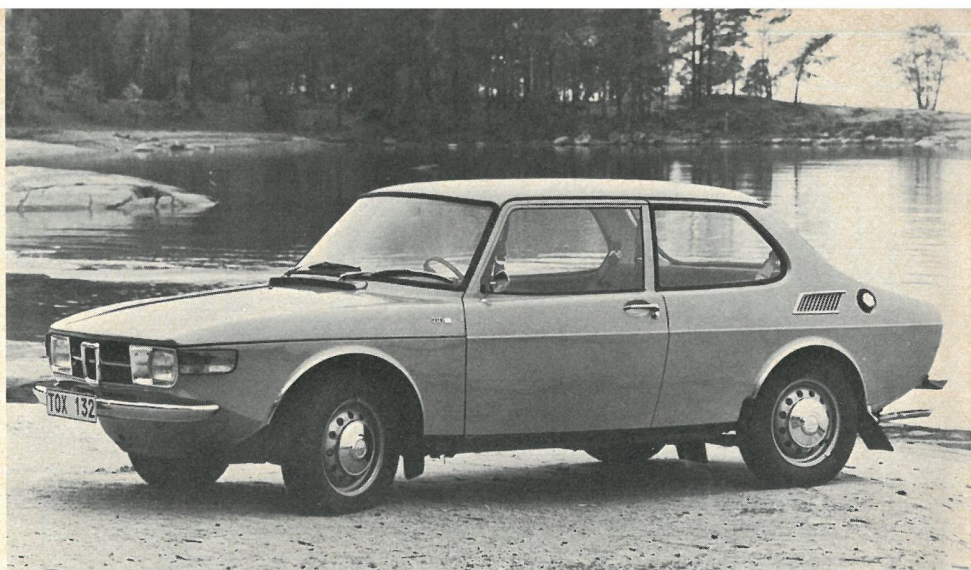
Saab 99 X7 med »gammeldags« kofangere og uden kromlister.
