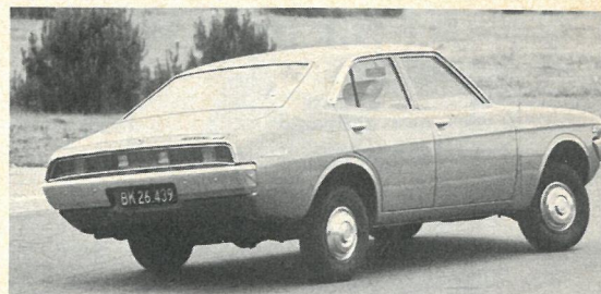
Baglygter, stoplygter, blinklys og baklygter er samlet i et bælte over kofangeren på Corona 2000 Mark II.
