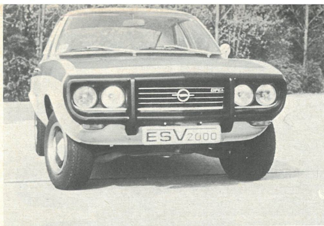
Opel arbejder i det stille med en række ESV-udkast. På billedet ses en modificeret Manta, som udover den typiske kofanger byder på væsentlige forandringer af den bærende konstruktion. Tegningen viser princippet bag det støddæmpende sæde-ryglæn.
