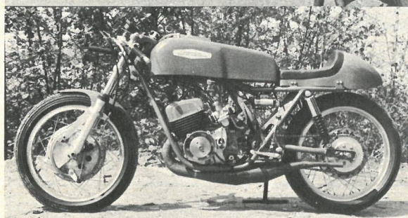
△ Den oprindelige encylindrede 125 ccm-racer er allerede i nogle år blevet solgt som production-racer. Dette er en 1969-version med omkring 20 hk ved 9.500 omdr./min. målt på baghjulet.
