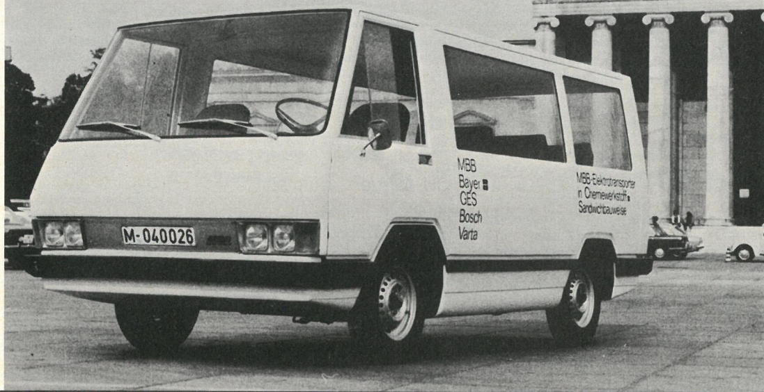
MBB's »Elektrotransporter« vejer ca. 2300 kg, hvoraf de 870 er batterivægt. Nyttelasten er 1000 kg og tophastigheden 80 km/t.
