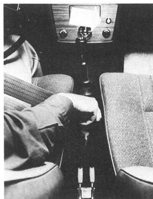
△ Volvos nyindførte kontrollampe (pilen), der forhindrer at man glemmer sikkerhedsselen.
