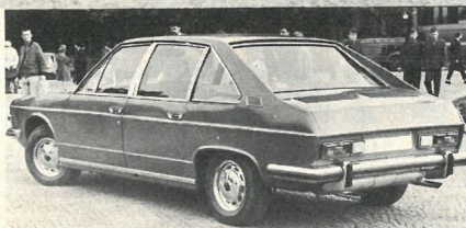
Tatra's nyeste hækmotormodel »613«, der foreløbig eksisterer i prototypeform. Karosseriet er tegnet hos Vignale i Italien.
