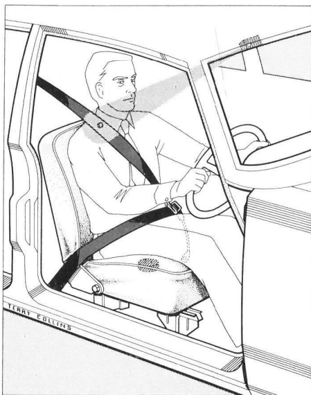
Det »idiotsikre« system består af en føler i sædet (C), en kontakt i låsen (B) og en reflektor (A) til ultralydssystemet.
