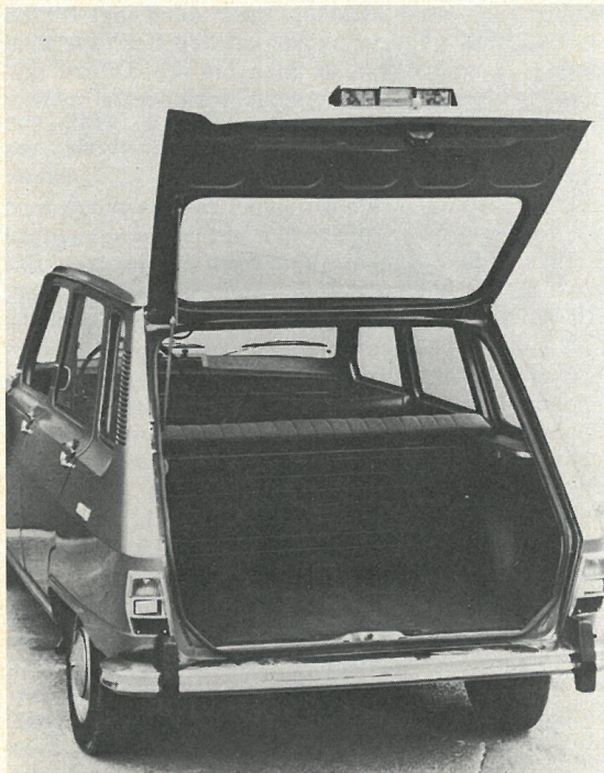
Den tophængslede bagdør giver god og bekvem adgang til bagagerummet, og man risikerer ikke at rive sig på den åbne dørs hjørner.
