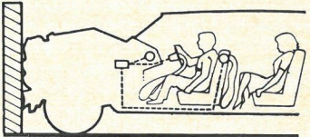
0,50 sek. efter sammenstødet Sikkerhedsluftpuden tømmes for luft og frembringer derved ingen hindringer.
