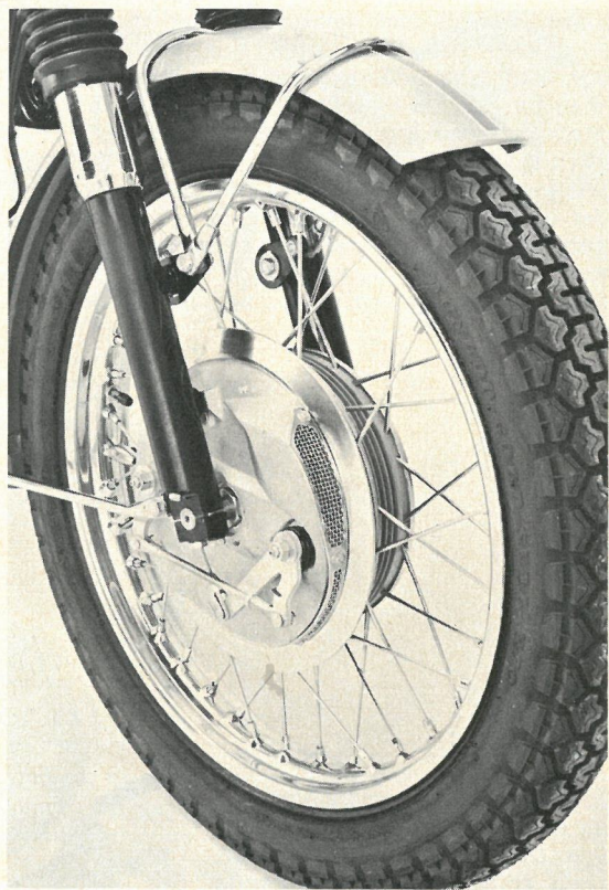
Den store og meget effektive forhjulsbremse. Foruden stoplygtekontakten ved baghjulsbremsen er der også en stoplygtekontakt indskudt på forhjulsbremSENS kabel. Bremsen har effektiv indvendig køling, og man kunne ikke spore tendens til fading.
