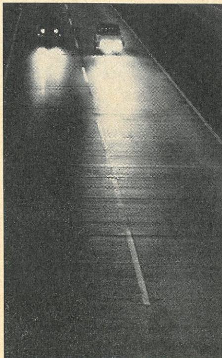
Vognen til venstre har konventionelle forlygter, mens vognen til højre er udstyret med jod-lygter. Man bemærker lysets større intensitet og den forøgede rækkevidde, navnlig i højre vejside (SEV-Marchal).
