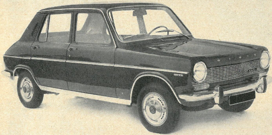
Simca 1100 med tværstillet fire-cylindret rækkemotor med forhjulstræk leveres som både to- og fire-dørs sedan, stationcar og varevogn. En forfriskende nykonstruktion i den rigtige automobiltekniske retning.
