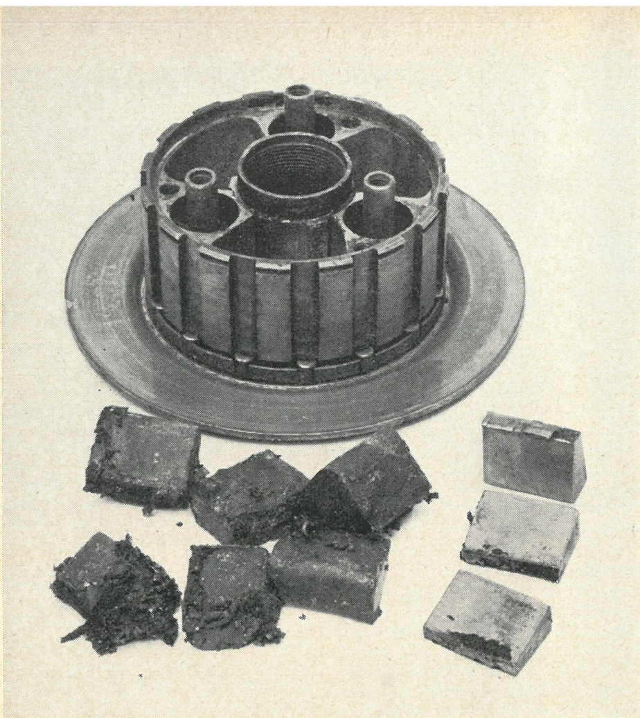
Ved demontering af koblingen så de støddæmpende gummiklodser således ud. De tre metalklodser længst til højre er de afbrækkede vinger fra det faste koblingsnav. Mellem bagpladen og det udvendige koblingsnav ses rullelejet, der bærer koblingskålen.
