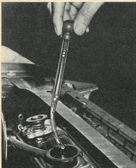
Blot et blik på kuglerne fortæller om frostsikringen.
