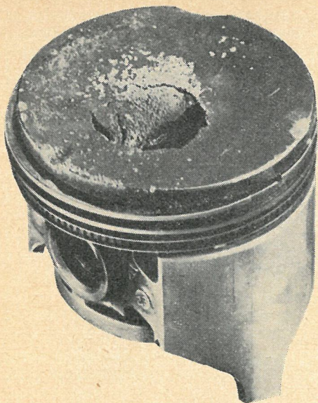
Et stempel ødelagt af ren tændingsbanken.
