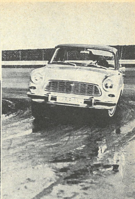
Til venstre ses den sæbemasse, som blev benyttet på Ford's prøvebane i Köln. Når man betragter de masser af brun sæbe, der hænger på hjulet og i skærmkassen, forstår man, at det ikke er den rene spøg at køre i. Til højre ses den benyttede Taunus 12 M under forsøgene.
