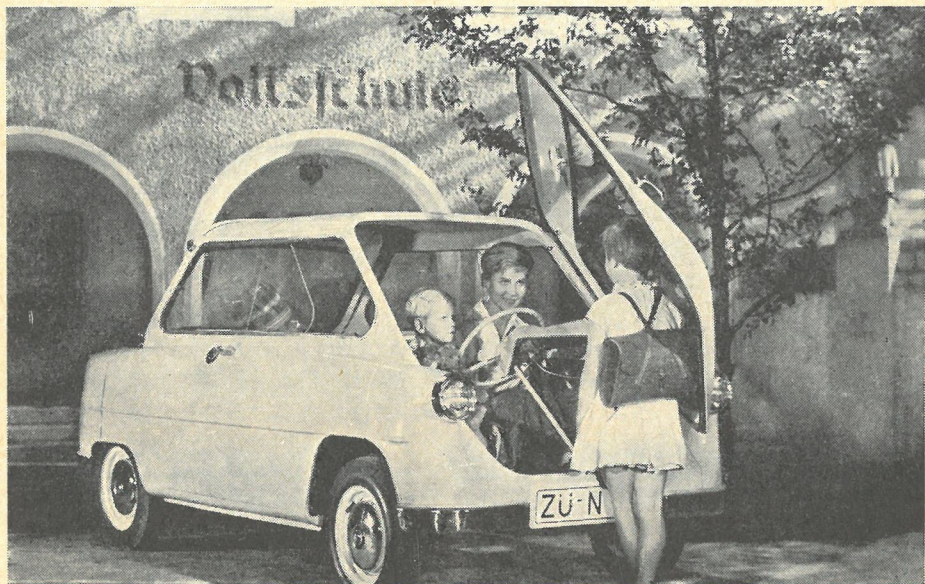
Vi har endnu ikke fået bestemt os til, om bagdøren skal være hængslet i taget eller i siden. Billedet her af JANUS viser, at man ved at hængsle den i siden kan få meget fine ind- og udstigningsbetingelser. Der er jo intet i vejen for, at vi kan lade en del af taget åbne med.
