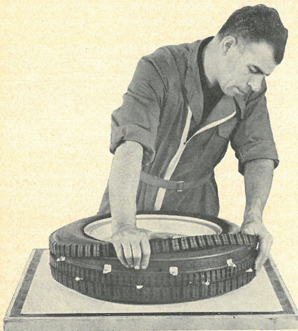
Forsøgsvis har man kørt med denne karkasse uden slidbane med 100 km/t over 700 km, uden at den tog skade.
