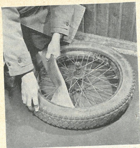
Slangen tages først ud diametralt modsat ventilen. Ved punkteringer må dækket undersøges omhyggelig for søm og lignende, inden den friske slange monteres igen. Når slangen skal lægges i, sættes ventilen først på plads, og man skal undgå snoner på slangen.
