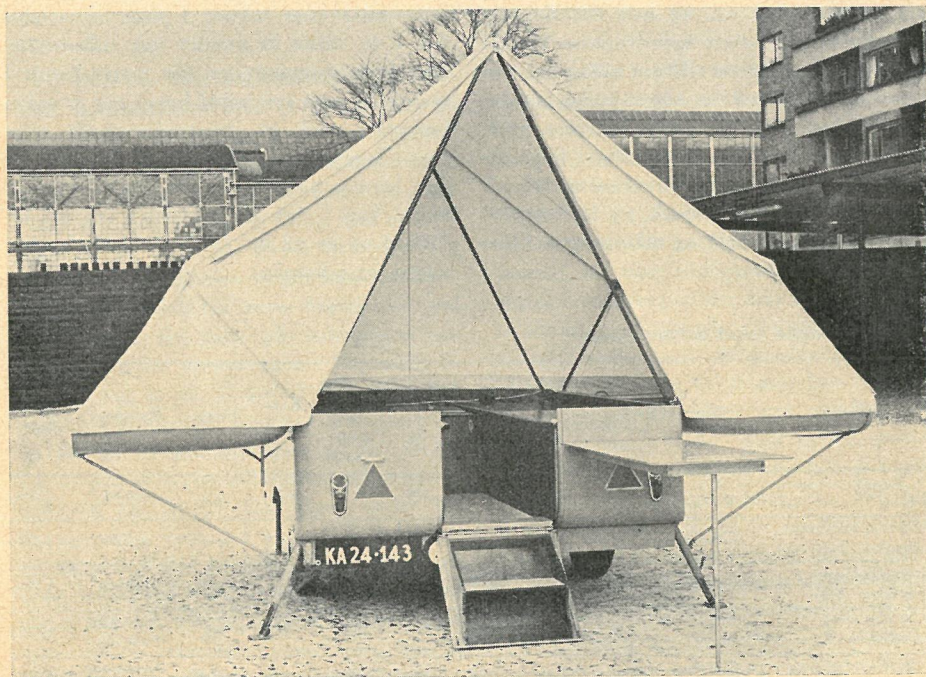
Her kigger vi ind i det opslåede telt, der har fire sovepladser. Frem for det almindelige telt har denne type campingvogn den fordel, at man ikke behøver at tage hensyn til underlag og jordbundsforhold. Det lille klapbord forrest til højre er ekstraudstyr.
