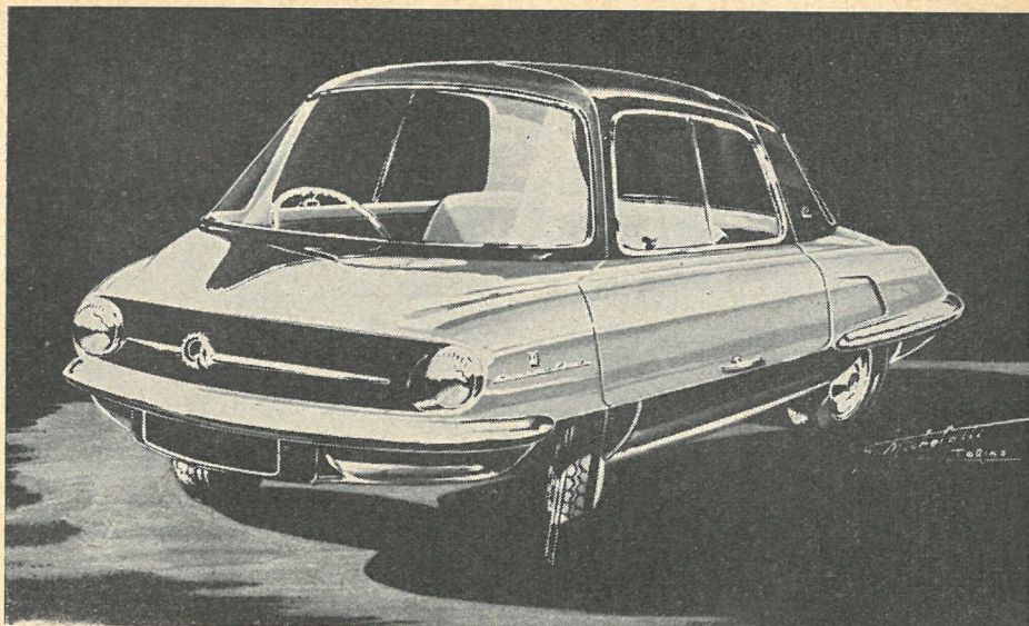
Det engelske svar på de tyske småvogne, Frisky, der er monteret med en to-cylindret 250 ccm Villiers motor, der yder 15 hk ved 5500 omdr/min. Der er fire fremadgående gear, men ikke noget egentligt bakgear. Når man skal køre baglæns, standser man motoren og starter den gennem dynastarten med modsat omdrejningsretning. Der er plads til to voksne og et barn på forsedet.
