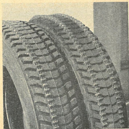
I Nardi's specielle vinterdæk er der afsat plads til to specialkæder, der kan bide sig fast i fastkørt sne og is uden at virke generende på tør vej.
