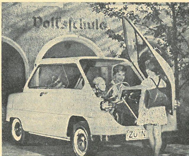
Indstigningen i Janus foregår fra vognens for- eller bagende. Det forfriskende ved dette lille køretøj ligger deri, at man ikke har forsøgt at skabe en vogn som en skalamodel af de store kendte vogntyper.
