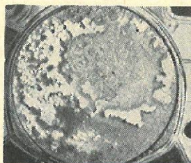
Forbrændingskammer. »Cornflake«-lignende aflejringer, der forårsager glødetænding . . . Resultat: Motorbankning, overhedning, krafttab etc.
