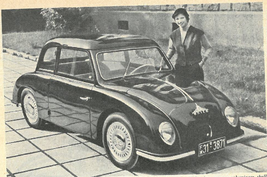
Maico Champion med to-cylindret, vandkølet to-takt motor anbragt bag i vognen. Ifølge importørens oplysninger skulle denne vogn komme til landet til konkurrencedygtig pris som firepersoners model og som varevogn.
