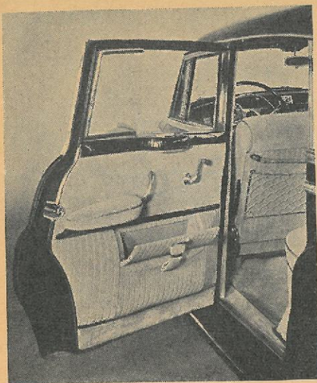
Udstyret i Mercedes »300« er blevet om muligt endnu mere luksuriøst. I dørens vindueskarm er indfældet et askebæger, og en småtingsbox udfylder den nederste del af døren. Et pakke-net er anbragt på forstolens rygstød.
