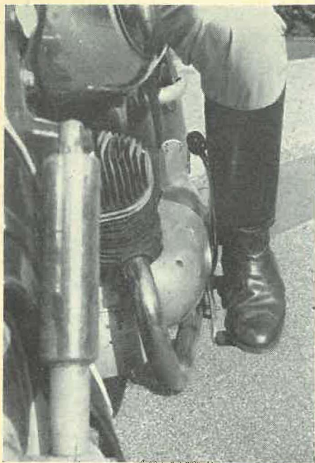
Pedalerne og fodhvilerne skal være anbragt på en sådan måde, at foden kan komme helt ind på fodhvileren, og gearpedalen skal kunne betjenes ved at vippe foden — benet holdes her ud fra tanken for at vise den bagved liggende kickstarterpedal.
