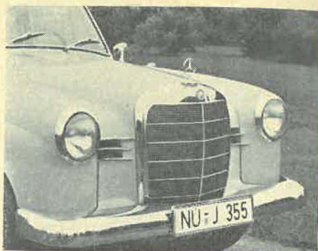
Også de fire-cylindrede modeller har fået ny front med en mindre, buet koleråbning.
