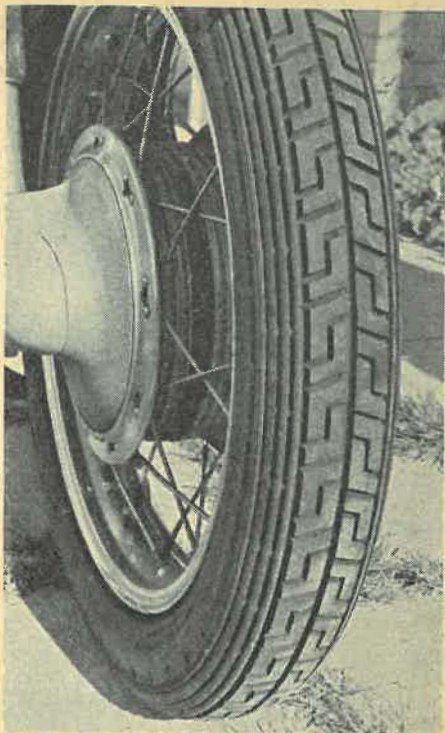
Det omtalte mønster på motorcykledækket, der giver anledning til styrende eller svømmende bevægelser på den groveste vejbelægning.
