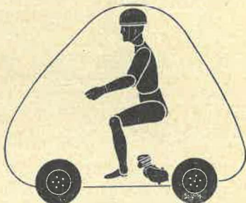
Her sidder manden på en scooter med 8" hjul, og vi har en høj, fuldstændig indkapsling af mand og maskine. En motorcykel af denne art vil være meget sidevindsfølsom.
