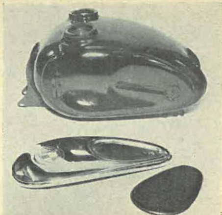
De forchromede sidestykker fastholdes af en fals fortil og en enkelt sætskrue bagtil, skruen er anbragt under gummipuden.
