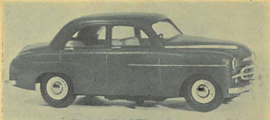
Dette er en Vauxhall i 1/16 størrelse. En ualmindelig smuk kopi, der trækkes ved hjælp af en elektromotor.
