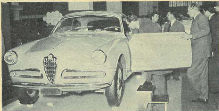
Alfa Romeo Giulietta Sprint — en pragtfuld personvogn i den dyre klasse. Fire-cylindret række-motor med to overliggende kædetrukne knastaksler. Boring 74 mm, slaglængde 75 mm, slag-volumen 1290 ccm, kompressionsforhold 8:1, effekt 65 hk ved 6000 omdr. min. Fuldsynkroniseret fire-trins gearkasse. Vægt 860 kg. Benzinforbrug ca. 9 liter pr. 100 km ifølge fabrikens opgivelser. Maksimalhastighed 160 km/t.
