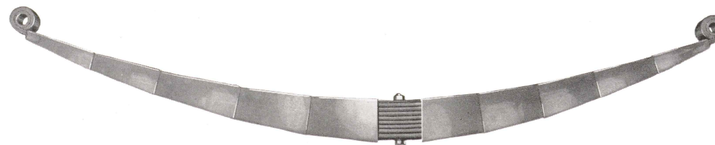
De nye Staal-Fjedergamasker holder Fjedrene smurte hele deres Levetid.
