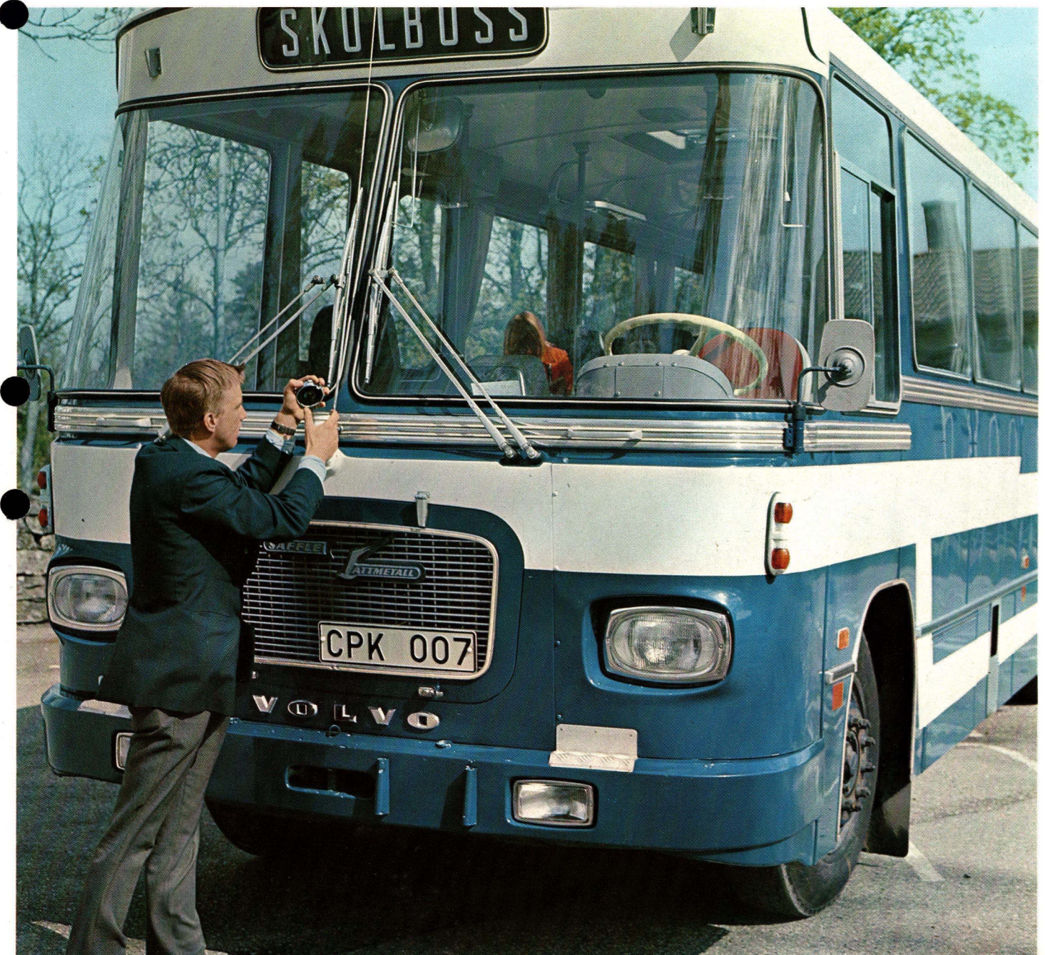
Den dagliga tillsynen sker snabbt och lätt. Oljesticka, oljepåfyllning och vattenpåfyllning sker vid ett ställe på B 57. Oljekontrollen på BB 57 görs vid motorluckan inne i bussen.
