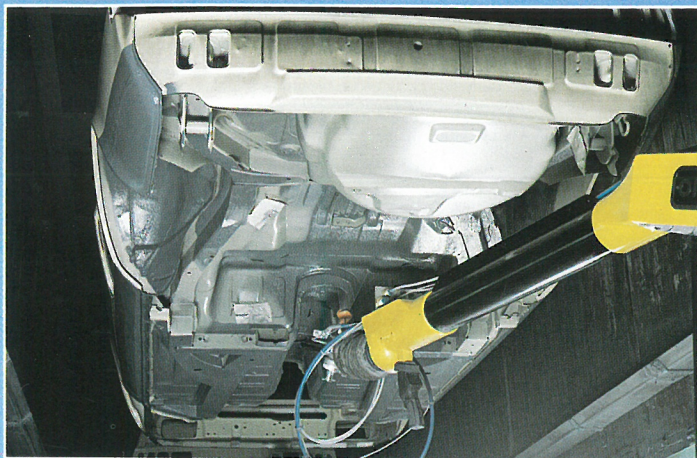
Hele undervognen forsynes med et stærkt PVC-lag.
