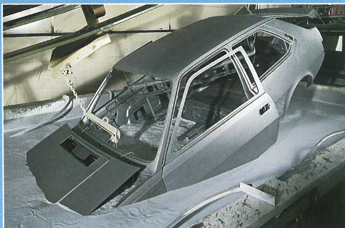
Total nedsænkning i et galvanisk bad giver sikkerhed for komplet behandling.
