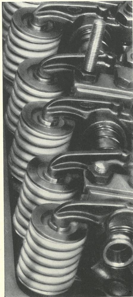
Hängende Ventile. Ausser den konstruktiven Vorteilen wird durch ihre leichte Zugänglichkeit ein bequemes Nachstellen und Kontrollieren des Ventilspiels gewährleistet.
