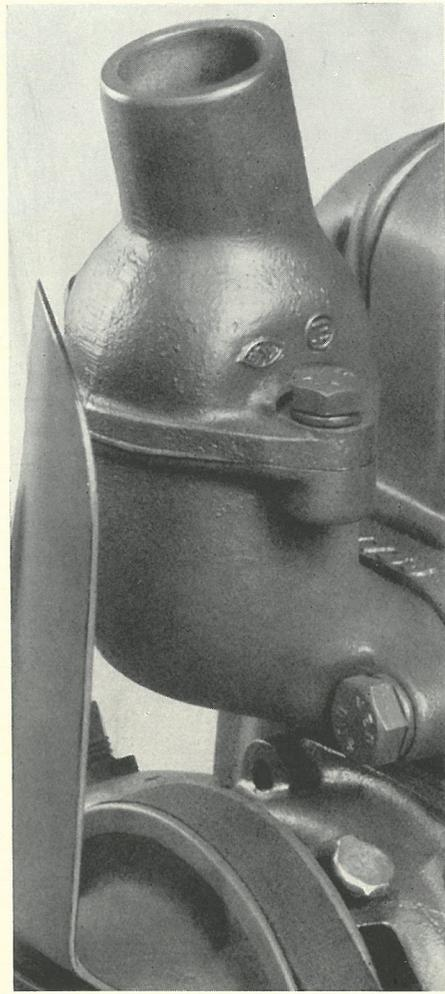
Der Thermostat hält die Kühlwassertemperatur automatisch auf der günstigen Höhe von etwa 70° C.
