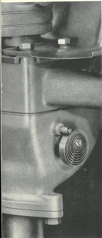
Die automatische Regelung der Gemischvorwärmung, eine neue Konstruktion, die den Grad der Beheizung des Gemisches vollkommen automatisch den wechselnden Erfordernissen anpasst.
