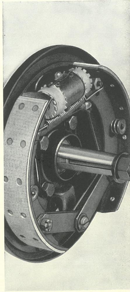
Hydraulische Betätigung der Öldruckbremsen, die einen völligen Ausgleich — also wirksamste Ausnutzung der Bremsflächen aller vier Räder ergibt.
