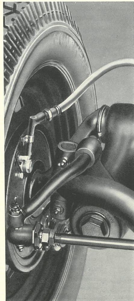
Das unabhängig aufgehängte Vorderrad mit Spiralfedern und hydraulischem, in das Federgehäuse eingebautem, doppelt wirkendem Stossdämpfer.
