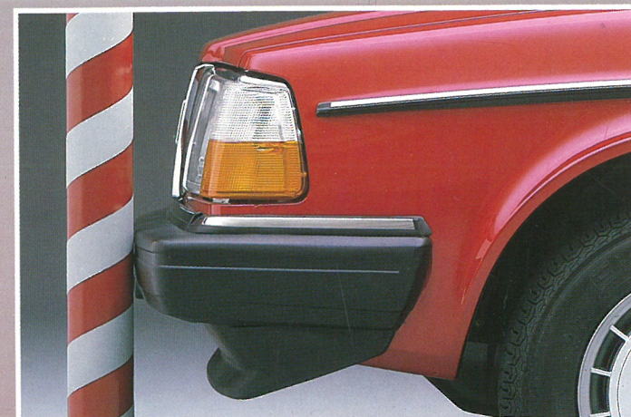
Kofangerne kan optage kollisionskræfter ved en hastighed af op til 4 km/t.
