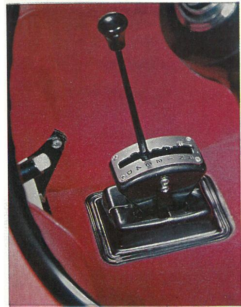
i samtlige gear – undtagen 1. gear – den fulde motorbremseevne, som man så ofte savner i biler med automatgear. En spærreanordning på startkontakten forhindrer Dem sågar i at starte motoren, medens vognen er i gear!
