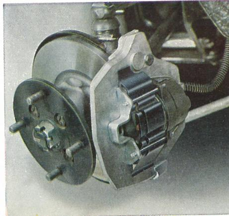
Austin 1300 har nykonstruerede, ekstra-kraftige skivebremser på forhjulene. 15 pct. mere effektiv opbremsning for samme pedaltryk – eller 15 pct. mindre pedaltryk og samme opbremsning!
