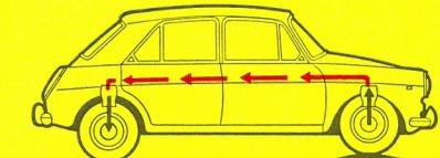
Forhjulene passerer en forhøjning – og bagvognen løftes tilsvarende.
