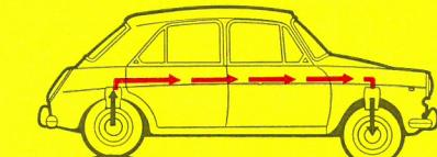
Baghjulene passerer en forhøjning – og forvognen løftes tilsvarende.
