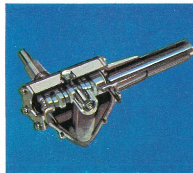
Styrtøjet er af snække- og taparmstypen og med høj virkningsgrad. Det er positivt virkende, og det 46 cm store rat giver sin fører et godt greb om tingene. Endvidere er alle modeller fra og med WF-K 120 monteret med servostyring.
