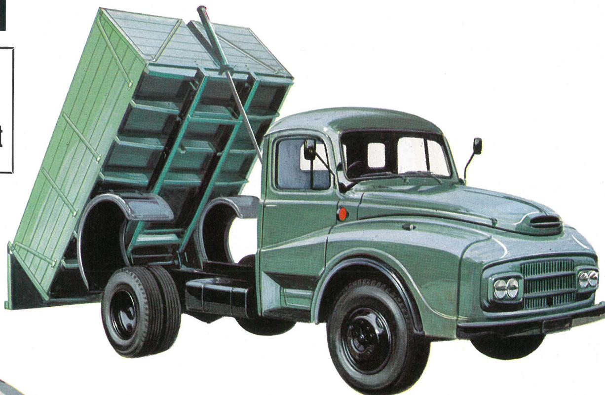
WF-K 60 / K 100 / K 120 er særdeles velegnet til opbygning med tippelad og kan med dette få følgende lادلængder i mm:
