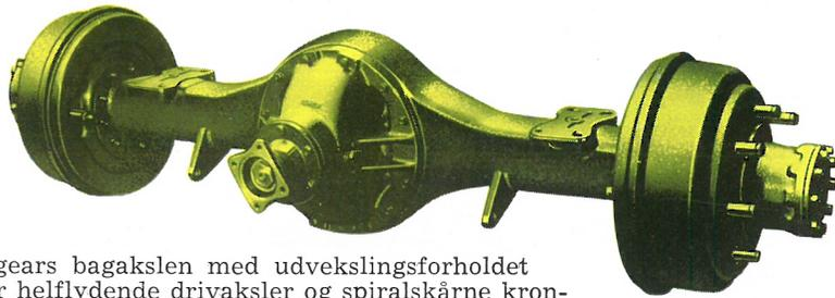
Enkelt-gears bagakslen med udvekslingsforholdet 7,2:1 har helflydende drivakslar og spiralskárne kron- og spidshjul. Hele differentialer er monteret som en enhed i en centerpart, der ligesom drivakslar kan monteres af bagakselhuset, uden brug af dunkraft. Om ønsket kan som alternativ til den ovenfor nævnte udveksling leveres udvekslingerne 5,85:1 og 6,66:1.
