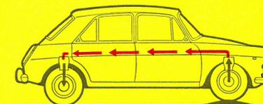
Forhjulene passerer en forhøjning — og bagvognen løftes tilsvarende.
