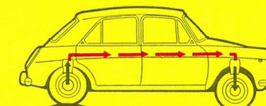
Baghjulene passerer en forhøjning — og forvognen løftes tilsvarende.
