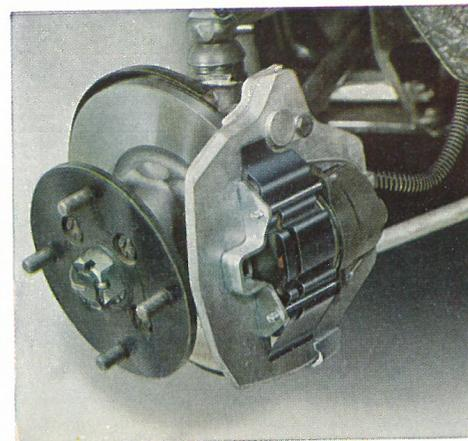
Austin 1300 har nykonstruerede, ekstra-kraftige skivebremsere på forhjulene. 15 pct. mere effektiv opbremsning for samme pedaltryk — eller 15 pct. mindre pedaltryk og samme opbremsning!
