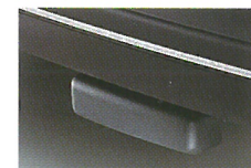
Trækkrogen er nem at montere og afmontere uden brug af værktøj. En hætte beskytter anhængertrækket, når krogen er afmonteret.
