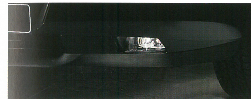
Tågelygten kan integreres i frontspoileren for at opnå et velafbalanceret design.
