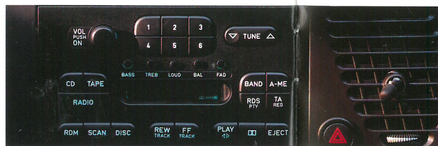
Den fabriksmonterede model kan udbygges med to dørhøjttalere (max. effekt 50 W) og en kraftig 2×40 W forstærker.
