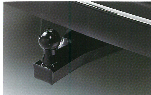
Fast anhængertræk, godkendt efter ISO specifikationerne og dynamisk testet af Saab. Det er konstrueret, så det presses nedad og væk fra benzintanken i tilfælde af kollision bagfra.
