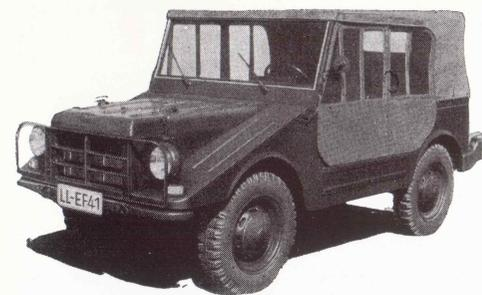
überwindung von 500 m. Diesen Höhenunterschied nimmt der Geländewagen (vollbeladen, ohne An- hänger) leicht. Mit An- hänger 30 Prozent Steig- fähigkeit. Wassertiefen von 50 cm können ohne Schwierigkeiten durchfah- ren werden. Auf normaler
