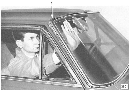
Bild 1 - Windschutzscheibe aus Karosserie, an einer oberen Ecke beginnend, herausdrücken
