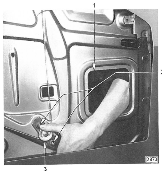
Bild 124 - Seil im Türinnern spannen durch Druck mit der Hand auf untere Seilrolle
