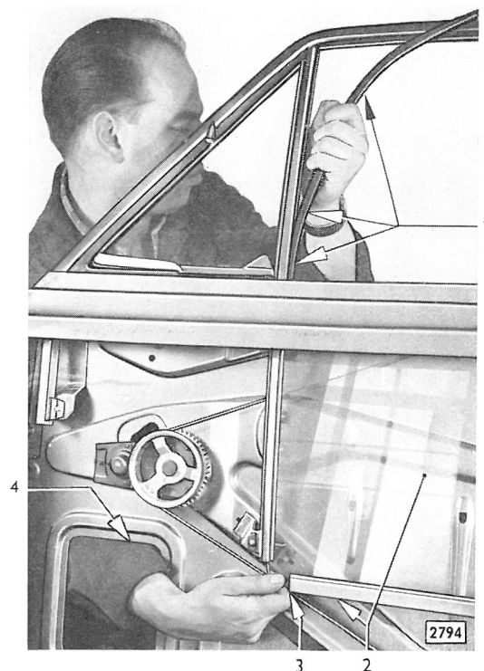
Bild 93 - Beim Einführen der vorderen Fallfensterführung nachhelfen durch Bewegen des Fallfensters im Türinnern
