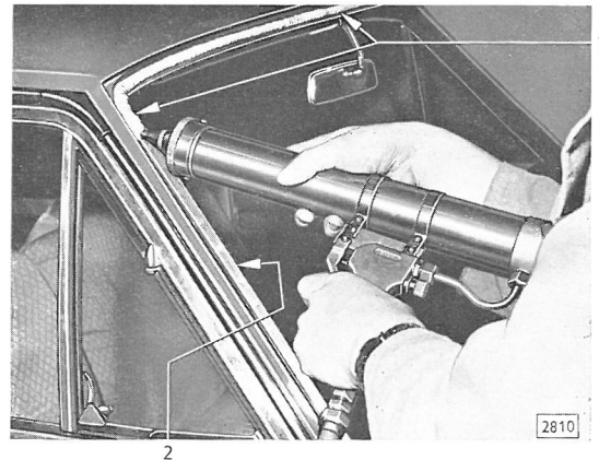
Bild 10 - Am Karosseriesteg außen Fensterdichtungsmasse L 000 779/5 mit Druckluftpresse auftragen
