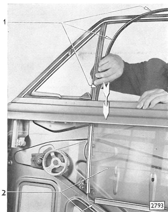
Bild 92 - Vordere Fallfensterführung in Fensterrahmen einschieben
