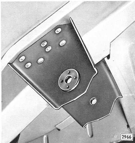
Bild 96 - Innere Hinterfederstütze an Steg des Hinterlängsträgers lochgeschweißt (Lichtbogen) – äußere Stütze in gleicher Weise lichtbogenschweißen (Schweißlehre bereits abgenommen)
