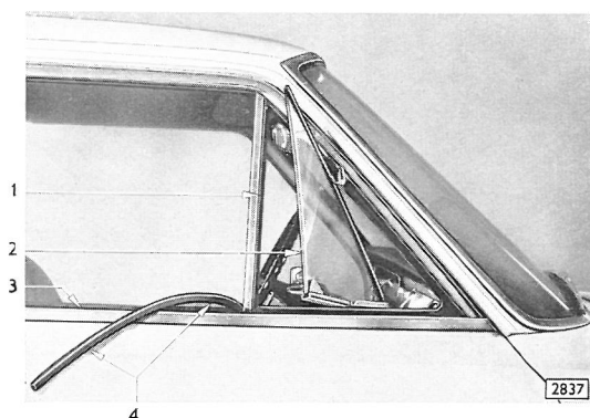
Bild 108 - Hintere Drehfensterdichtung im Fensterrahmen
