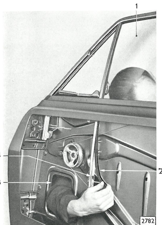
Bild 81 - Vordere Fensterführung im Türinnen aus Fensterrahmen herausziehen
