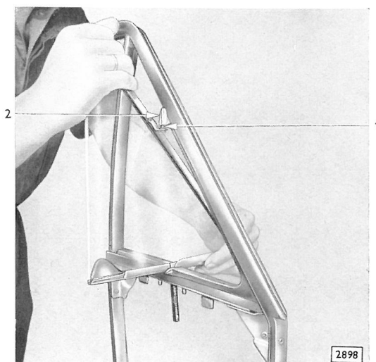
Bild 52 - Drehfenster in Fensterrahmen einsetzen
