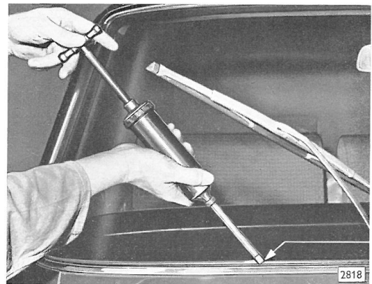
Bild 18 - Zwischen Windschutzscheibe und Gummifassung mit Fensterdichtungsmasse L 000 779/5 auslegen (Handdruckpresse)
