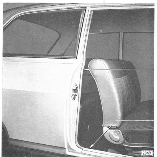
Bild 59 - Verkleidung auf Schloßsäule – Einstiegleiste noch nicht eingebaut
