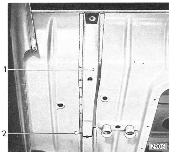
Bild 72 - Hinterlängsträger-Hinterteil vom Bodenblech trennen – hier durch Ausbohren der Schweißpunkte
