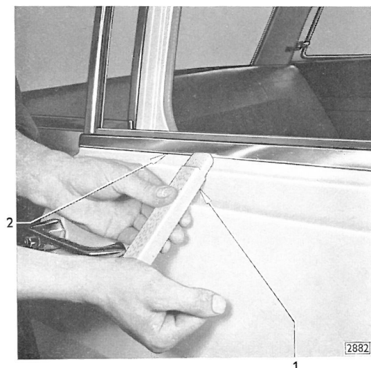
Bild 101 - Schachtzierleiste an Tür ausbauen
