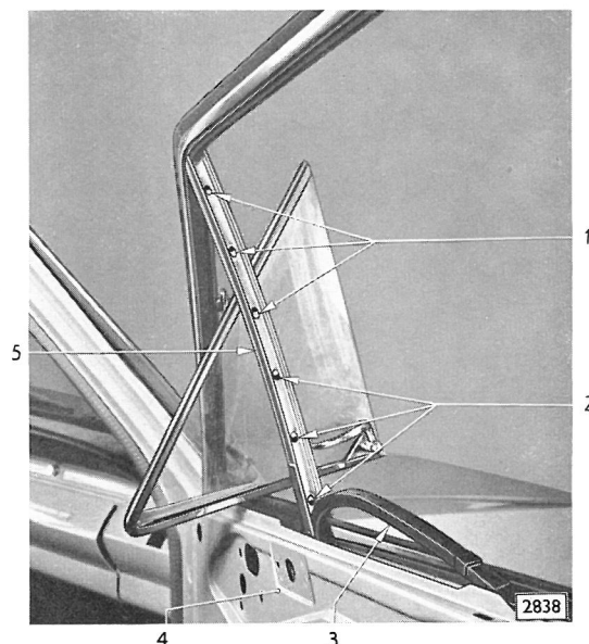
Bild 109 - Haltezungen der hinteren Drehfensterdichtung am Fensterrahmen
