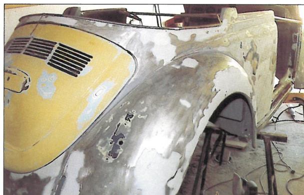
Karosseri og skærme blev befriet for mange lag mystisk lak med en varmpistol, og derefter sletet i bund, inden behandling med grunder m.v.
