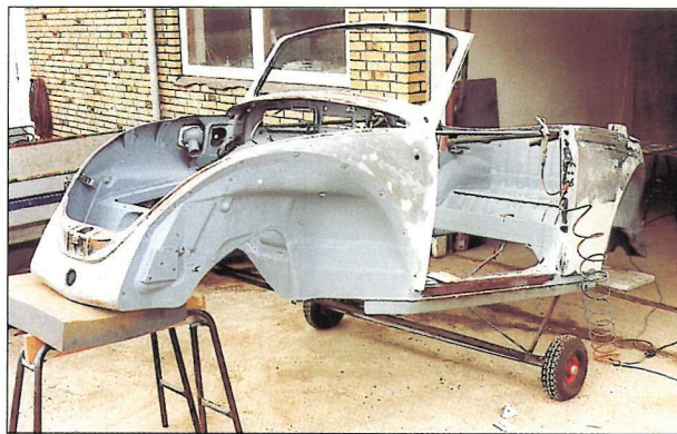
Karosseriet monteres på en lille vogn - dette letter transporten og giver god adgang til undersiden når der som her skal grundmales.
