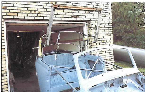
Kaleche-stativet var meget medtaget, og måtte fornyes flere steder - bl.a. er der monteret nye "trædele", og alt er malet grundigt efter sandblæsning.
