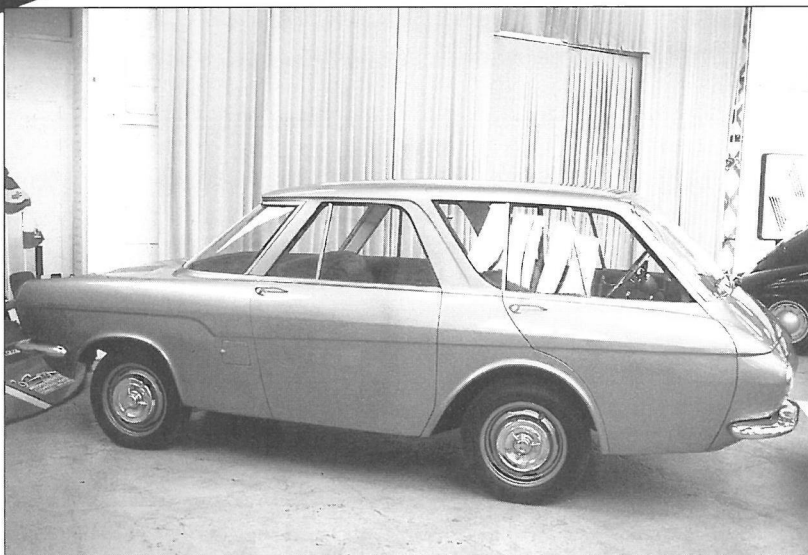
Renault type 900 1959 prototype med hækmotor.
