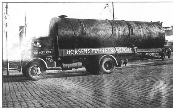
Vognmand Chr. Mortensen ønskede firmanavnet Horsens Flyttetransport påført ladsiderne. For at få en glat side blev de tildannet af to sekstommer (150 mm) brædder, der blev sløffet sammen, limet og tykkelseshøvlet. Lastbilen er en Fordson 1946.
